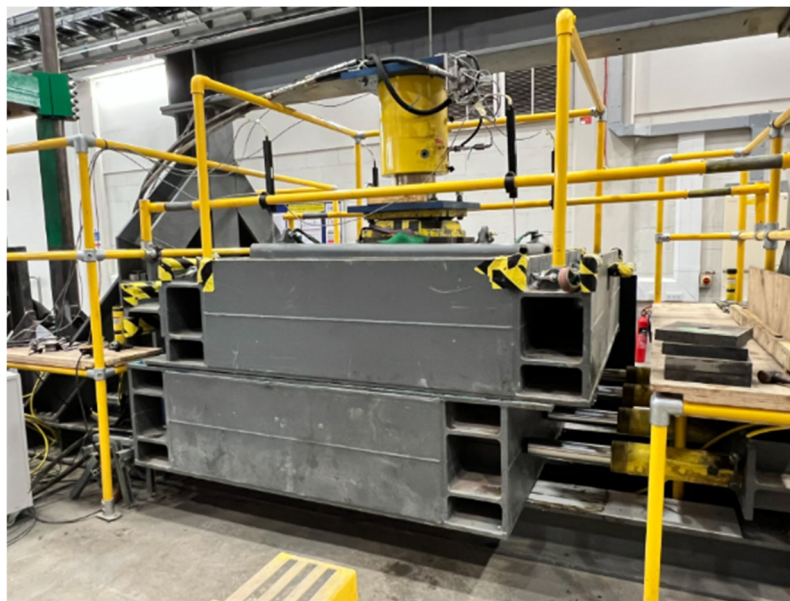
Fot. 6. Widok wielkowymiarowego aparatu bezpośredniego ścinania
