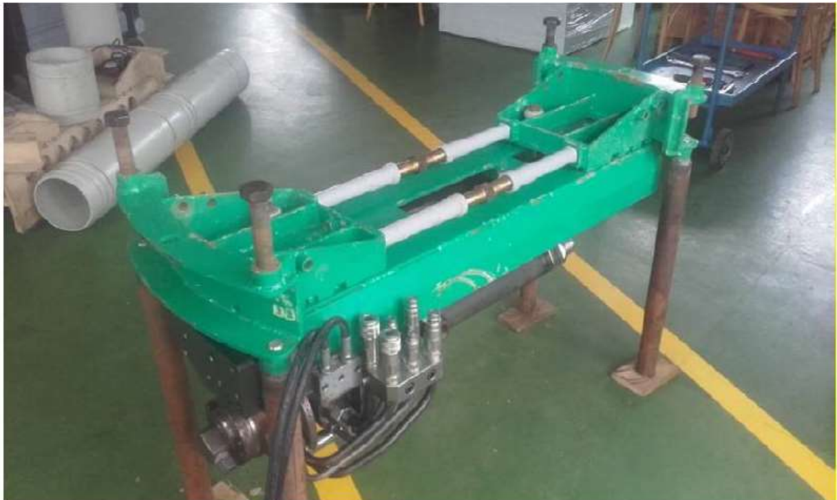
ZDJĘCIE Najnowsza wersja Wiertnicy Grawitacyjnej WG 12-3 na stojaku po testach w terenie.
