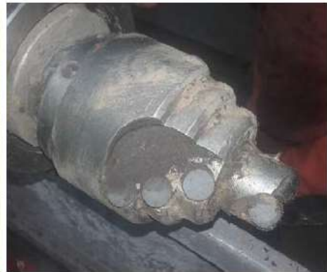
ZDJĘCIE Testy zestawu wiertniczego z podwójnym napędem obrotowym (po lewej). Narzędzia wiertnicze do podwójnego napędu (od góry): gryzer, świder wiertniczy.
