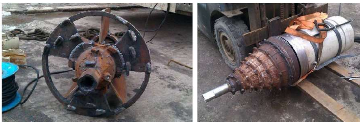
ZDJĘCIE Poszerzacz (po lewej) i rozwiertak (po prawej) do rur fi 500.
