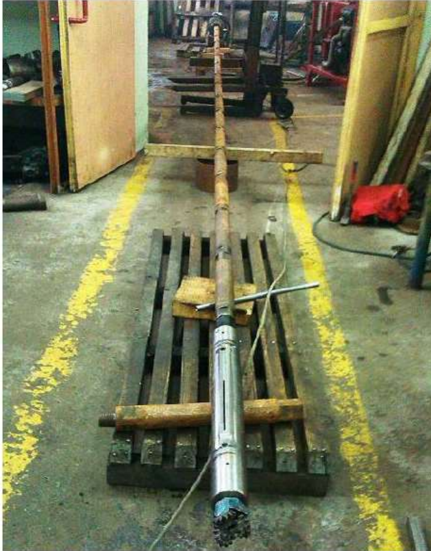
ZDJĘCIE Testy zestawu wiertniczego z podwójnym napędem obrotowym (po lewej). Narzędzia wiertnicze do podwójnego napędu (od góry): gryzer, świder wiertniczy.
