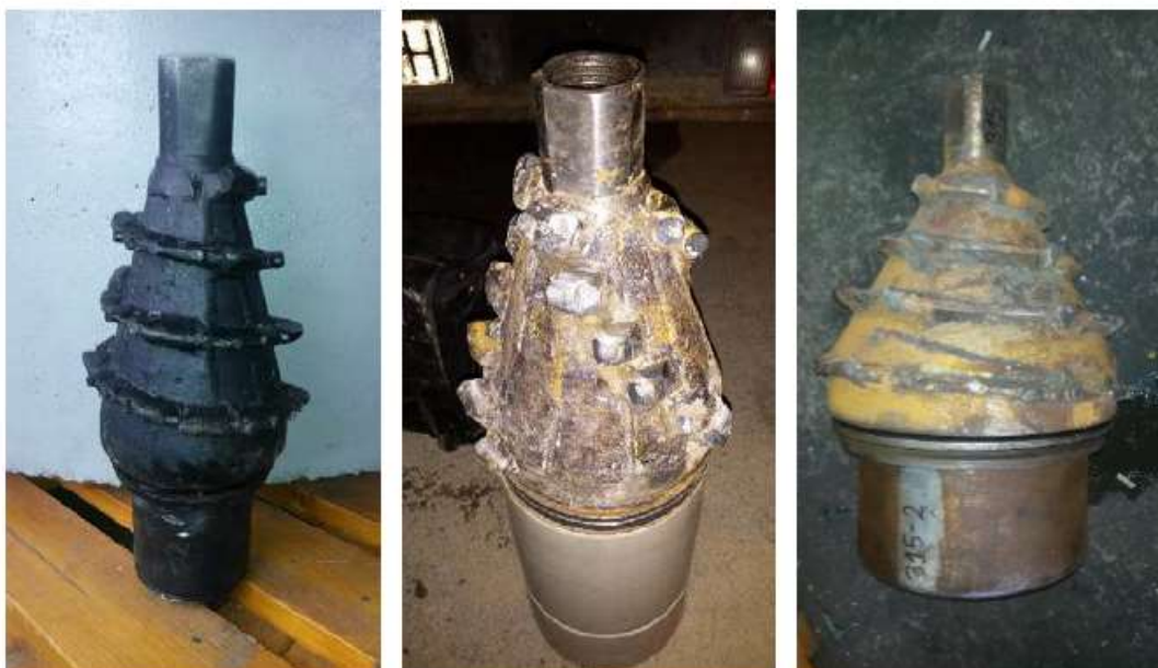
ZDJĘCIE Rozwiertaki (od lewej): 180 ślimakowy, 225 (z rurą startową) do skały, 315 ślimakowy
