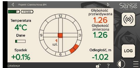
Przecisk bezpłuczkowy sterowany 52m z wykopu prostokątnego (PE160, Wodociągi Suszec)
