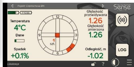
Przecisk bezpłuczkowy sterowany, odcinek 52m z wykopu prostokątnego (PE160, Wodociąg Suszec, grunty zwarte piaszkowe)
